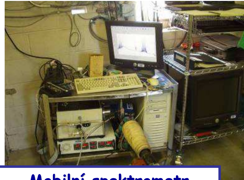
Mobilní spektrometr FTIR prototyp, 2004-2006
